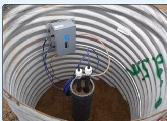
• Protection parafoudre pour les piézomètres à corde vibrante
