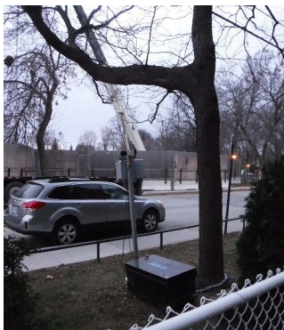
Solution de surveillance du son et des vibrations installée dans le quartier.
