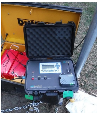
Installation d'un Sismographe.
