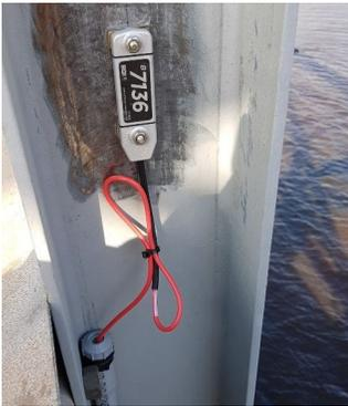
Installation d'une jauge de déformation
