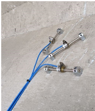
Rosette de jauges de déformation à corde vibrante installée sur l'âme d'une poutre
