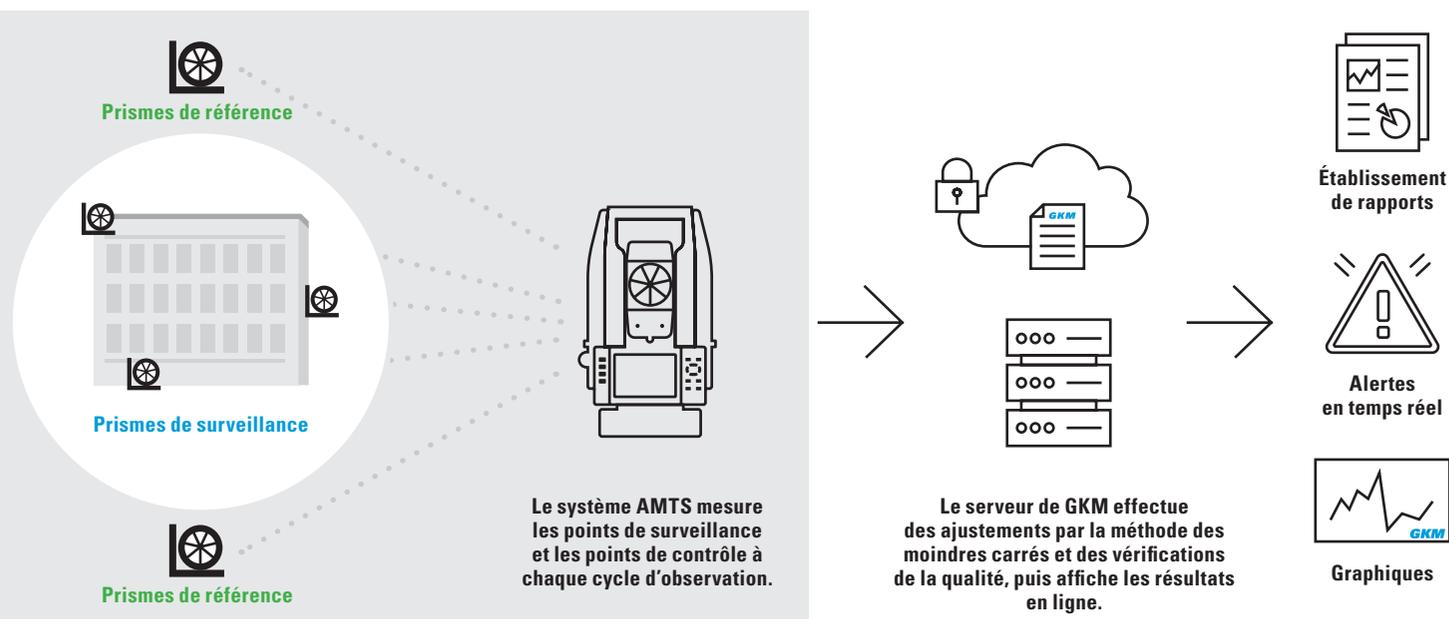
Le site Web du projet offre des outils permettant de tracer des données et de générer des alertes et des rapports. Les positions des cibles peuvent être reportées sur des vues cartographiques ou des vues en plan pour faciliter la lecture.
